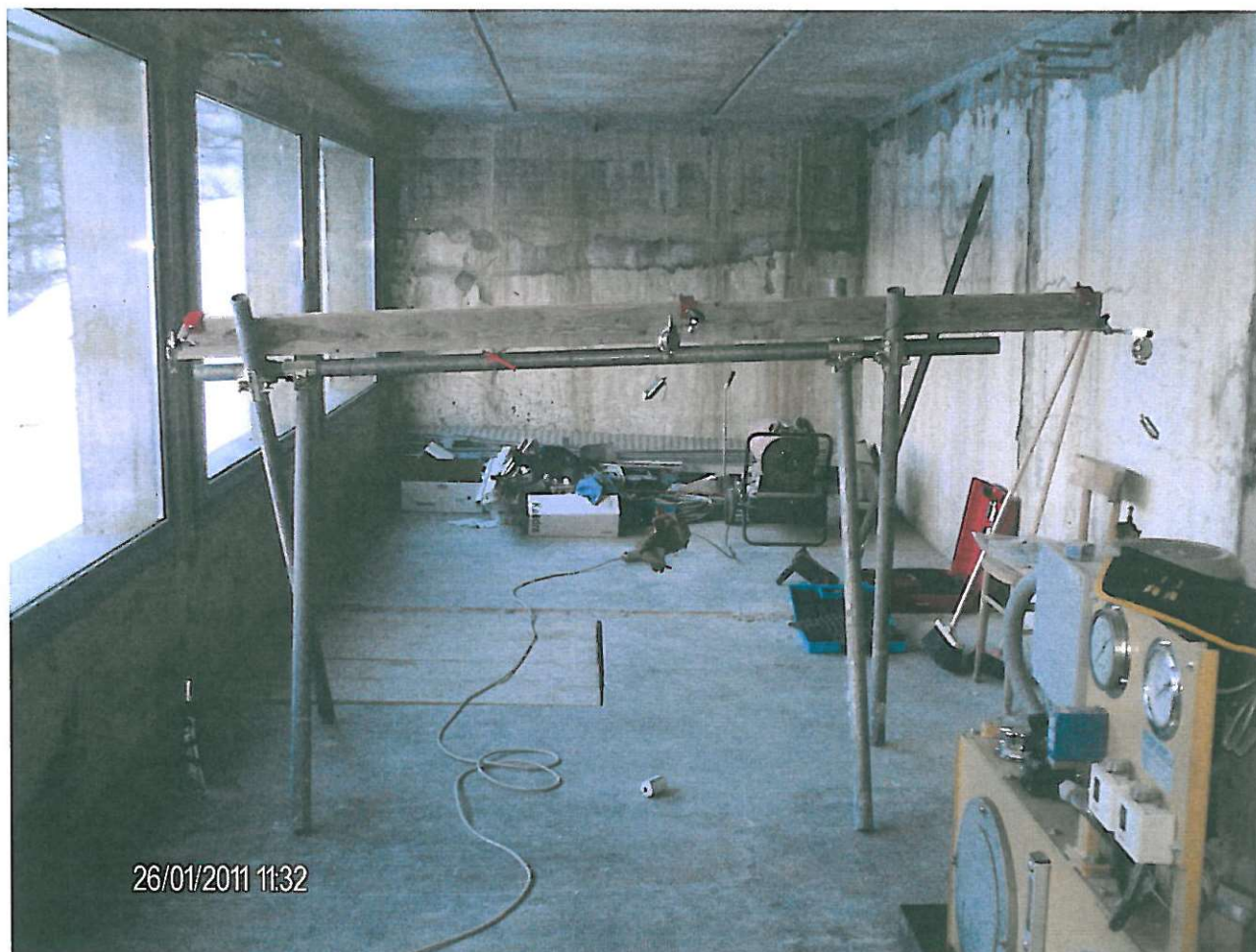
Da sinistra verso destra si vedono gli estensimetri nn. 1, 2 e 3
